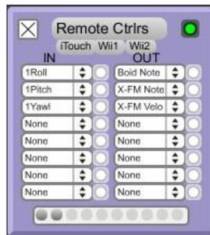
Assim, os atos de inclinação nos três eixos (*Pitch*, *Yawl*, *Roll*, conforme a angulação geométrica tridimensional de Euler) e de aceleração (que agrega a quarta dimensão) do movimento do controlador remoto são transduzidos segundo essa escala de variáveis flutuantes em dados que podem ser enviados aos sintetizadores do Sistema HTMLI, assim como também utilizados para controlar um processo de espacialização, isto é, de movimentação virtual de uma fonte sonora pelo ambiente da performance.
